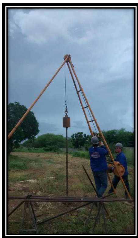
Imagem 02: execução do ensaio de sondagem SPT.
