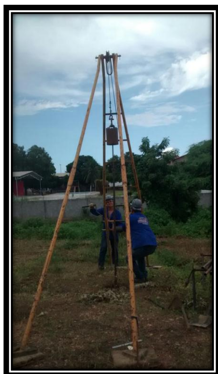
Imagem 03: execução do ensaio de sondagem SPT.
