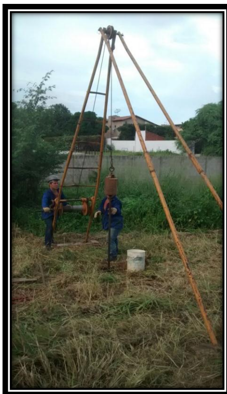
Imagem 01: execução do ensaio de sondagem SPT.
